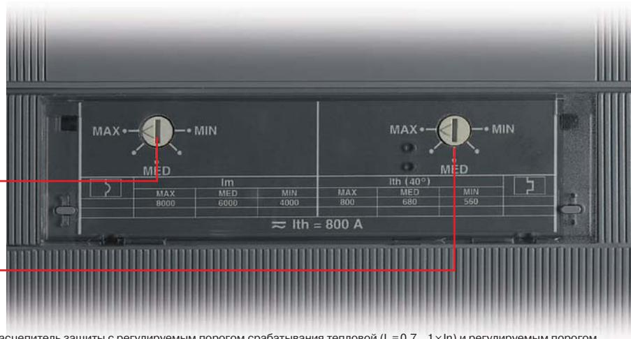
TMA = термомагнитный расцепитель защиты с регулируемым порогом срабатывания тепловой ( $I_1 = 0,7...1 \times I_n$ ) и регулируемым порогом срабатывания ( $I_3 = 5...10 \times I_n$ ) магнитной защиты
