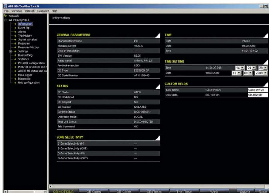
ПО Ekip Connect автоматически сканирует шину RS-485, обнаруживает все подключенные устройства и проверяет их конфигурацию, с контролем всех возможных комбинаций адресов, четности и скорости передачи данных. Простое нажатие на кнопку SCAN покажет:
