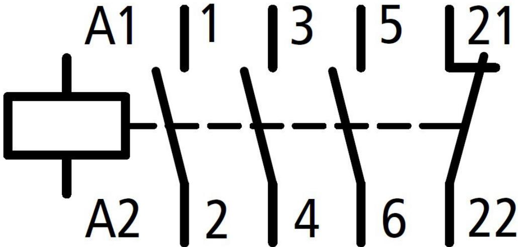
**Габаритные чертежи: Контактор 11 кВт/400 В, 1 Н.З., катушка 24 В пост. тока**
