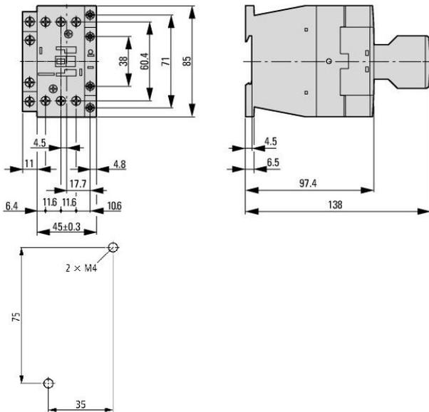
**Габаритные чертежи: Контактор 15 кВт/400 В, 1 Н.О. , катушка 230 В перем. тока**
