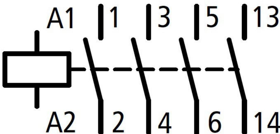
**Габаритные чертежи: Контактор 15 кВт/400 В, 1 Н.О. , катушка 230 В перем. тока**
