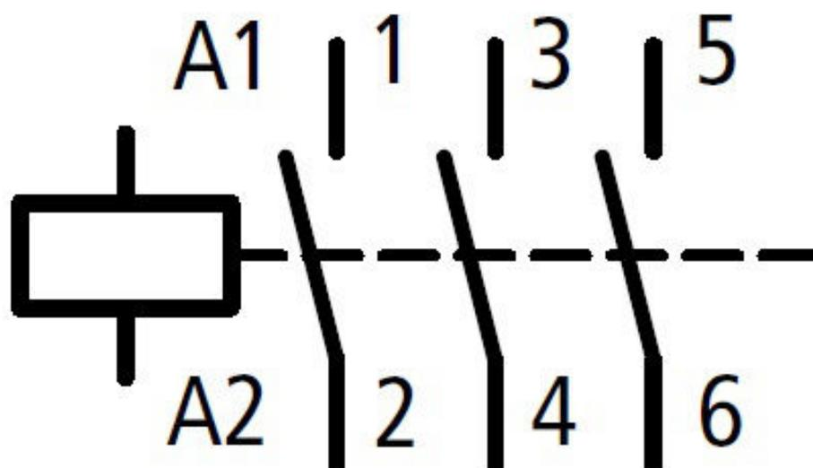
**Габаритные чертежи: Контактор 18,5 кВт/400 В, катушка 24 В пост. тока**
