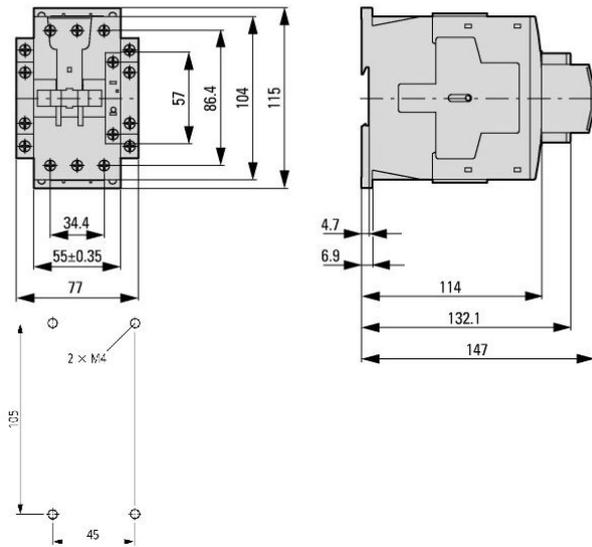
**Габаритные чертежи: Контактор 18,5 кВт/400 В, катушка 24 В пост. тока**
