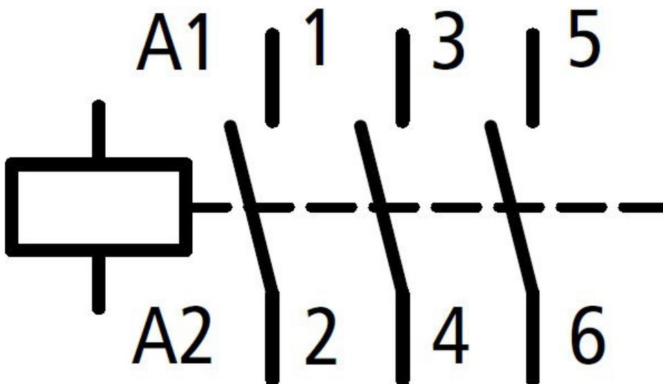
**Габаритные чертежи: Контактор 22 кВт/400 В, катушка 230 В перем. тока**
