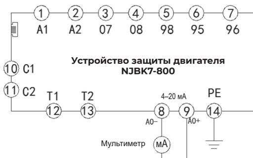
Рис. 16. Схема соединений проверки интерфейса 4–20 мА
