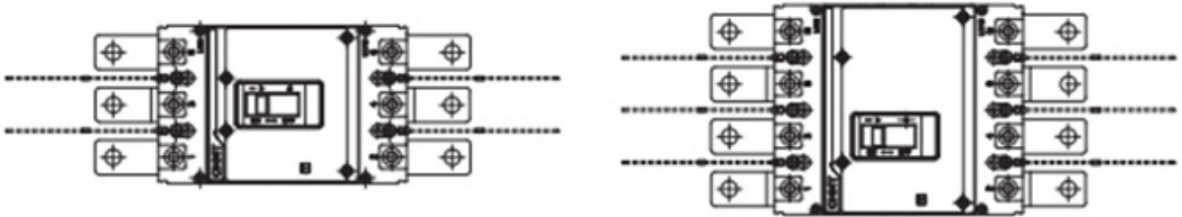
Рисунок 9. Схема установки соединительной пластины NXM(S)-63, 125, 160, 250
