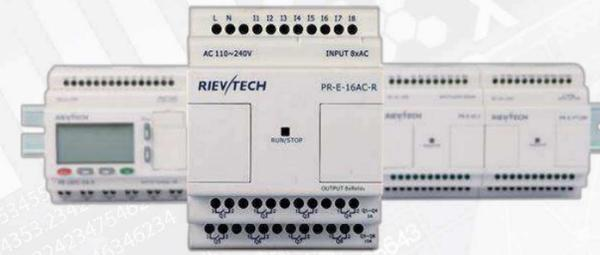
▲ Расширение путем подключения до 16 модулей.
