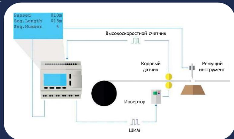
▲ Пример приложения: управление высокоскоростным счетчиком, позиционированием и функциями-ввода-вывода с помощью одного и того же устройства.
